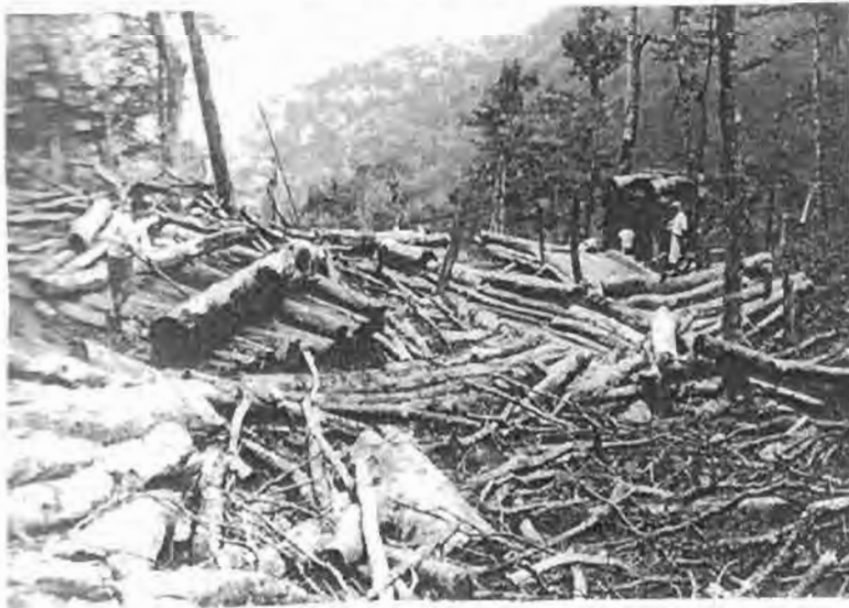
上西作業地. 左方の盤台へ集積架線へ入った枝 は. 傍羅へ落すと同時に. 作業軌道へ. 後. 台車へ積込まれる
